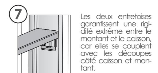
Les deux entretoises garantissent une rigidité extrême entre le montant et le caisson, car elles se couplent avec les découpes côté caisson et montant.
